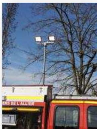
Photo 81A6 : Mât d'éclairage d'un VPI
