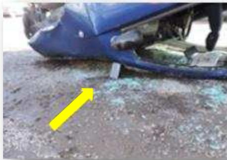
Photo 81A12 : Calage du montant d'une VL sur le toit avec contact du moteur au sol
