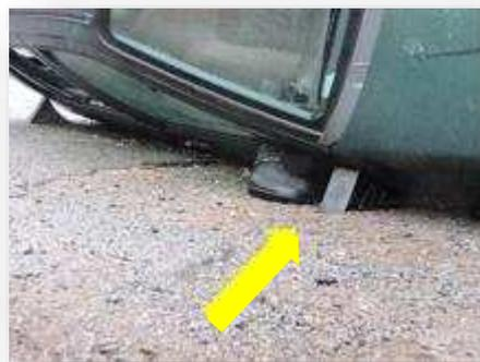
Photo 81A11 : Calage d'une VL sur le flanc avec les cales du VSAV
